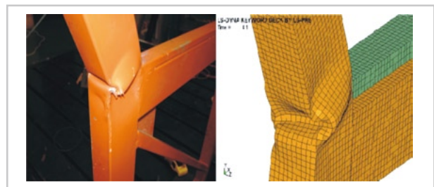
▲ 圖16. 骨架接點試驗與骨架電腦模擬比較
