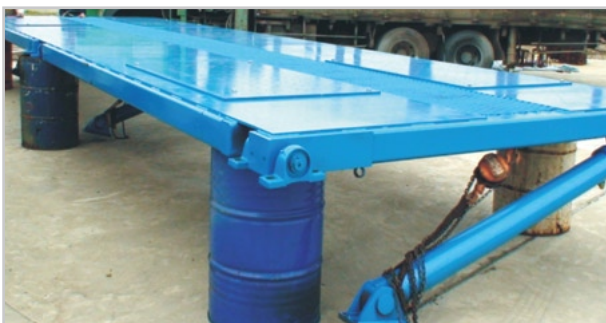
▲ 圖9. 翻覆平台結構
