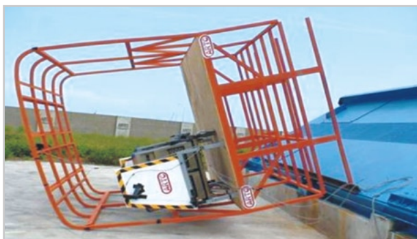
▲ 圖2. 等效試驗-車身段翻覆試驗圖
