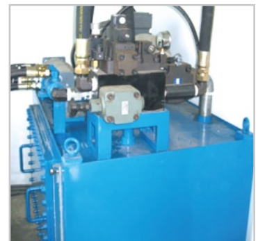
▲ 圖12. 油壓動力系統
