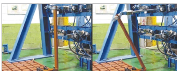
▲ 圖21. 骨架接點試驗作動圖
