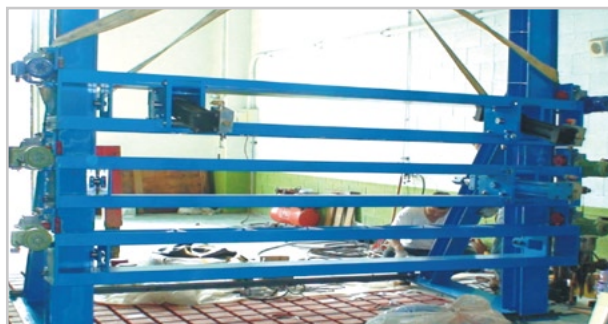
▲ 圖20. 油壓缸設備架組裝
