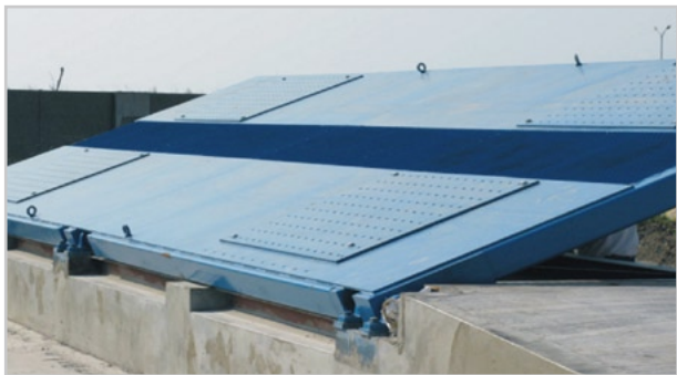
▲ 圖14. 整車翻覆平台翻覆傾斜情況
